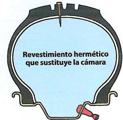
Válvula fijada a la llanta
