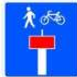
Calzada sin salida excepto para peatones o ciclos. Figurará el pictograma del o de los usuarios a los que afecte la excepción
